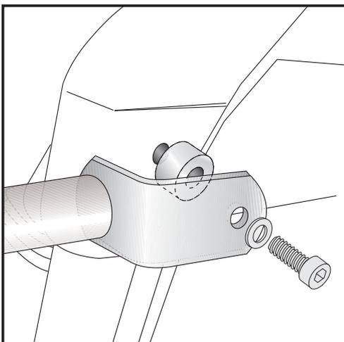
**3** Montage des Motorschutzbügels oben links und rechts:
