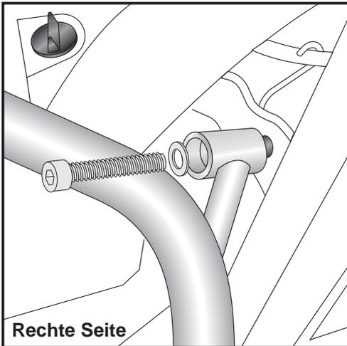
**2** Montage des Motorschutzbügels mitte links und rechts:
