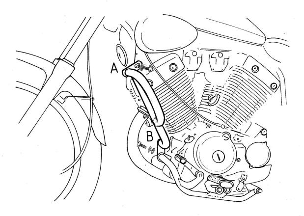
Der Bügel ist auch passend für Motorräder mit vorverlegten Fußrasten!
