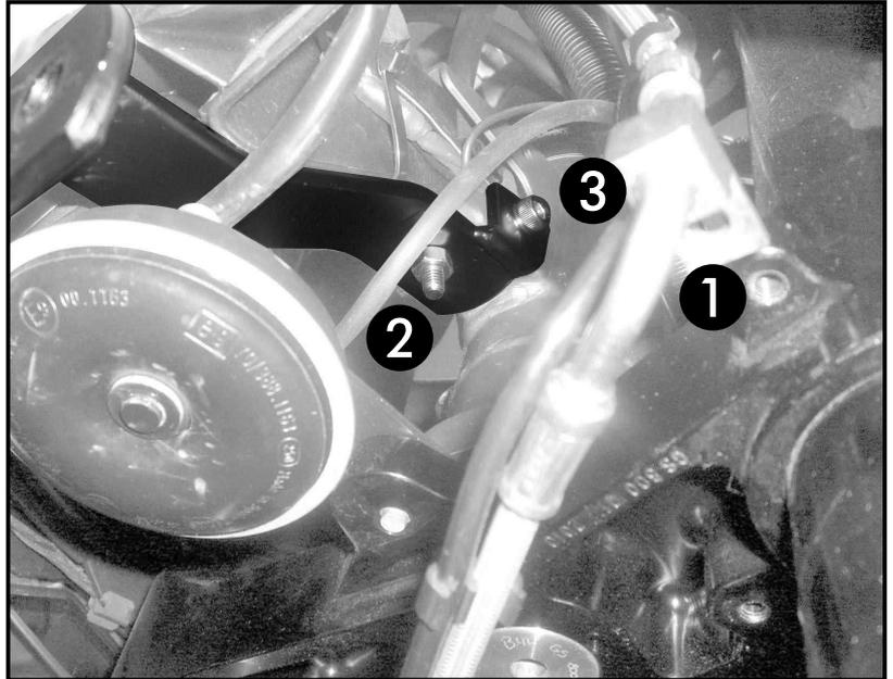
Befestigung des Tankschutzbügels oben:
