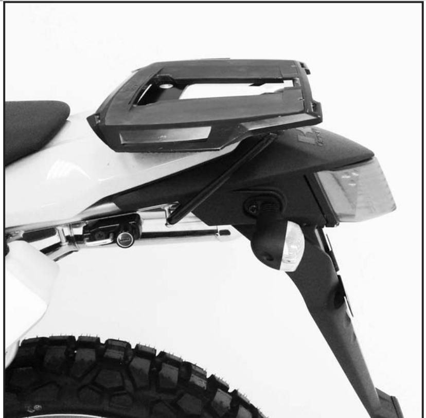
**Achtung: alle Verschraubungen erst handfest anziehen und dann die Einzelteile ausrichten.
