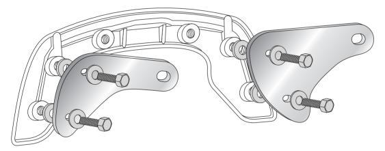
Den C-Bow mit den montierten Halteadaptern an den freien Bohrungen der Chromleiste am Fahrzeug verschrauben. Hierzu die Inbusschrauben M10 x 90 x 1,25 mit U-Scheiben ø10,5 verwenden. Zwischen Halteadaptern und Chromleiste die Distanzen ø18 x ø11 x 40mm einfügen.
