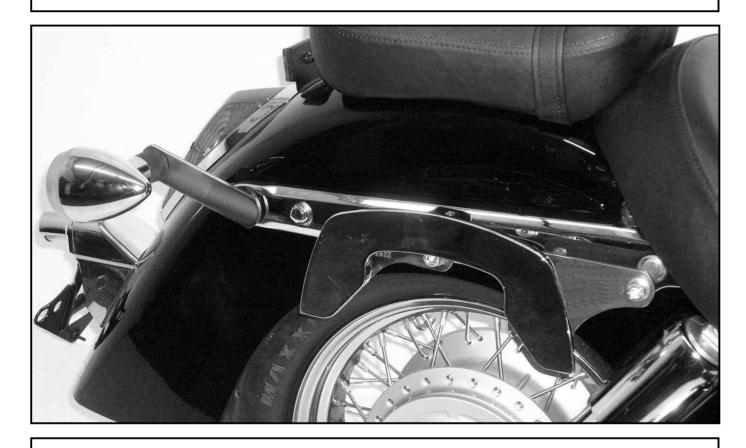
Ziehen sie alle zugänglichen Schrauben zuerst nur locker an. Nachdem alles montiert ist, werden die Schrauben dann auf das entsprechende Anzugsmoment festgezogen.
