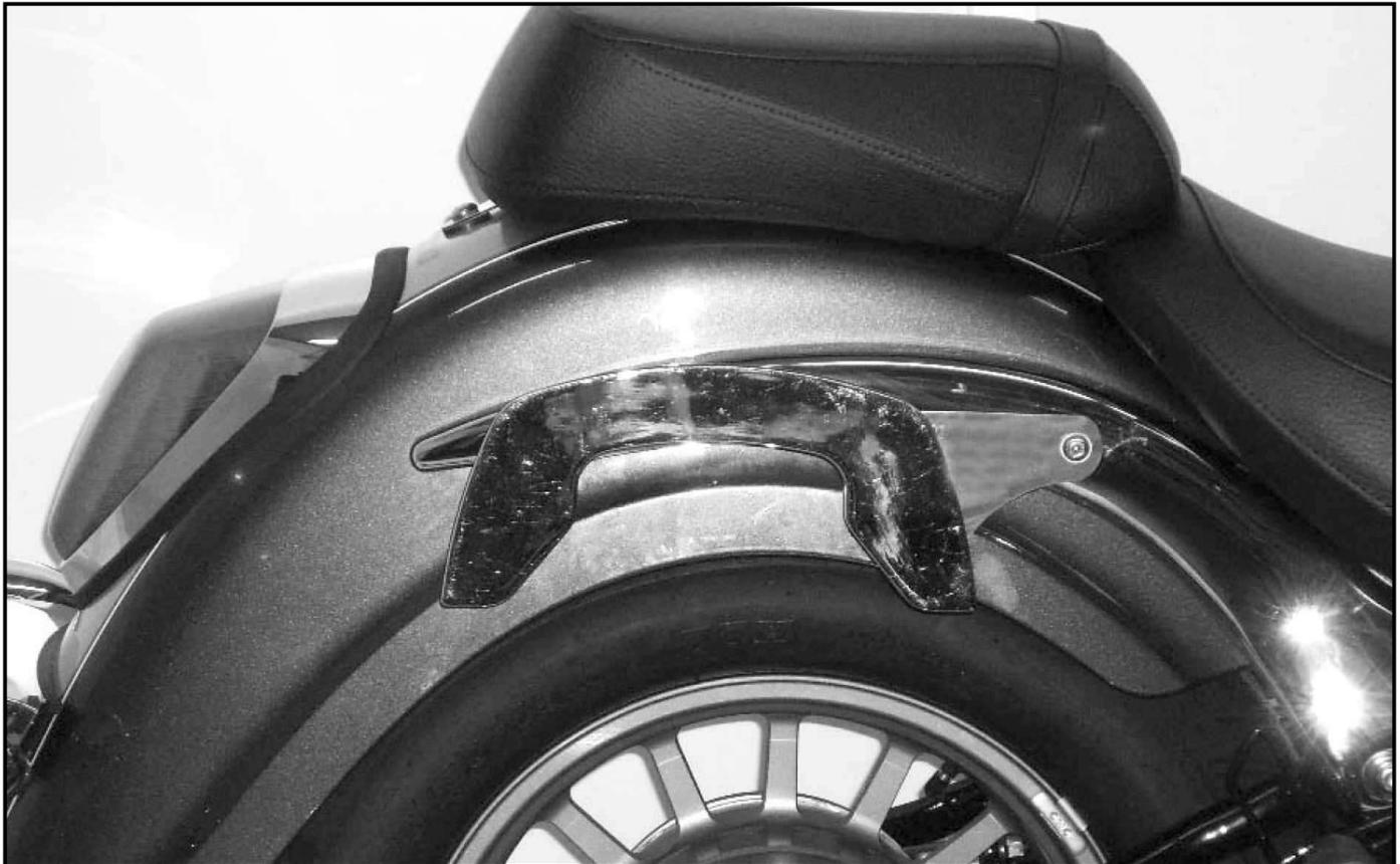
**Ziehen sie alle zugänglichen Schrauben zuerst nur locker an. Nachdem alles montiert ist, werden die Schrauben dann auf das entsprechende Anzugsmoment festgezogen. Dadurch wird sichergestellt, dass das Produkt spannungsfrei angebaut ist. Schrauben zusätzlich mit Sicherungsmittel sichern. Anzugsmomente des Motorradherstellers beachten!**
