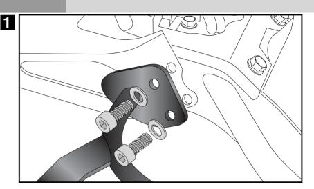
Montage des Halteadapters rechts vorne: Den Halteadapter rechts vorne mit der Linsenkopfschraube M8x35 zusammen mit dem originalen Aluminium Gurtadapter montieren auf dem Federbein montieren.
