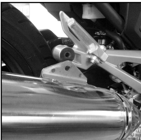
**3** Die Schrauben der Auspuffaufhängung vorne und hinten ausdrehen, den Topf nach unten ziehen und dann nach außen (siehe Bild).
